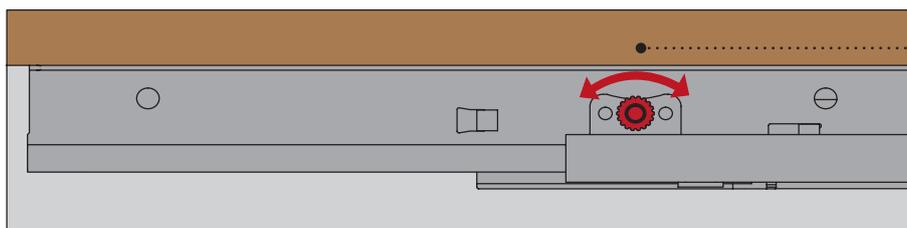
Вращая гайку у основания "пина" получаем регулировку по высоте 0 + 3 мм
