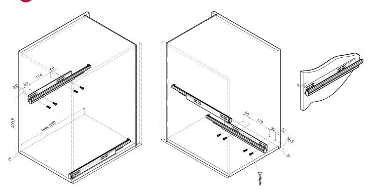
Минимальная глубина каркаса до задней стенки 520 мм
