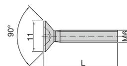
Винт М6х30мм, головка потай, отделка цинк
