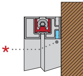
\* LED лента 5 мм. арт. **M-E.2835.120.9,6.20.NW.32** + гибкий рассеиватель 4x10 мм арт. **M-E.0410.5000.PR.SL** (заказывается отдельно)
