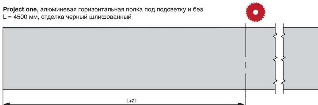
**!** Важно: L – расстояние между двумя вертикальными базовыми профилями R6615
