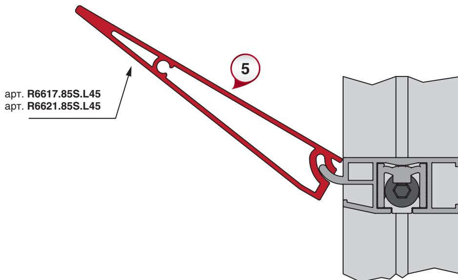
установка комплекта торцевых заглушек для горизонтальных полок R6617.85S.L45 и R6621.85S.L45
