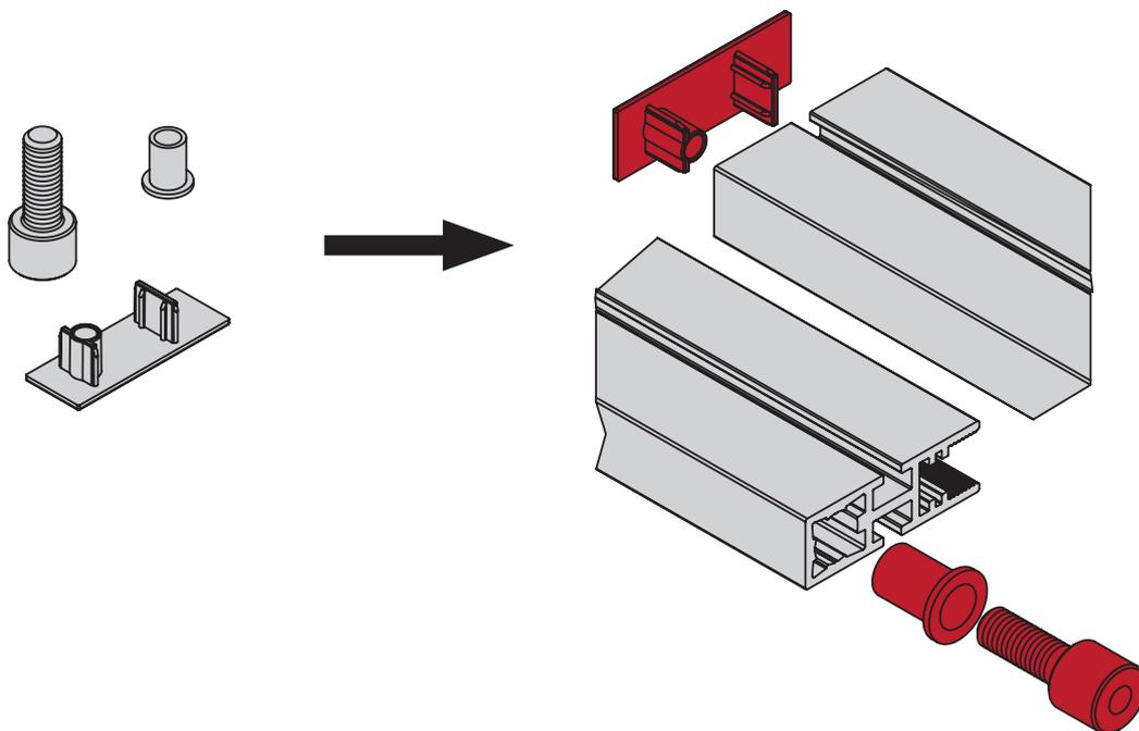
установка комплекта торцевых заглушек для профиля R6615
