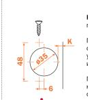
К – возможное расстояние фрезеровки под чашку от края фасада 3-6 мм.
