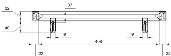
**2** СХЕМА ПРИСАДКИ КРЕПЛЕНИЙ ПОЛКИ НА БОКОВУЮ ПАНЕЛЬ КАРКАСА
