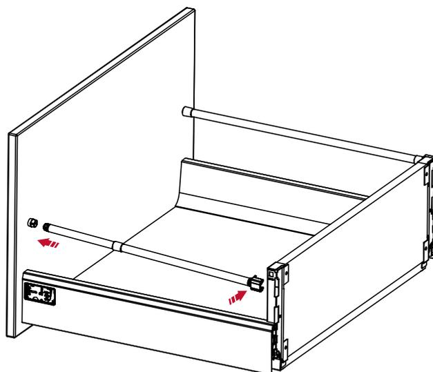
**8** Соедините рейлинги с фасадом и задней стенкой.
