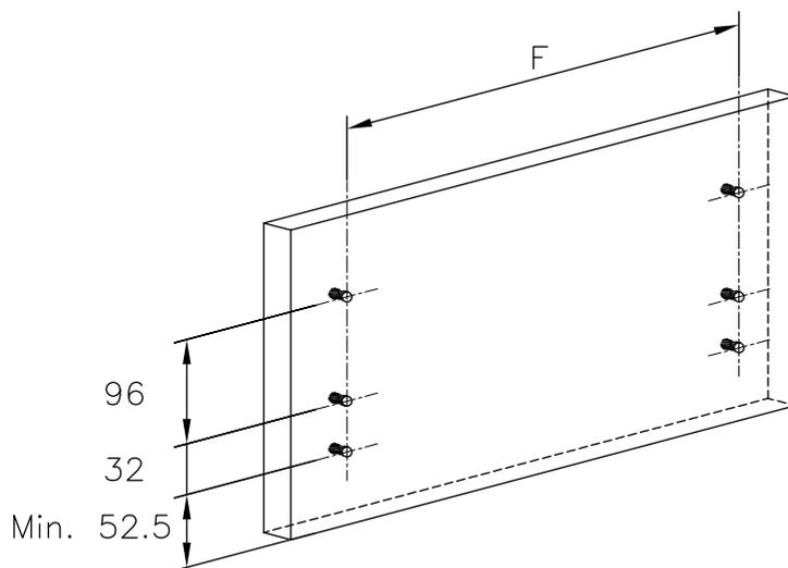
Расстояние между отверстиями на фасаде (F) = внутренняя ширина шкафа – 31 мм
