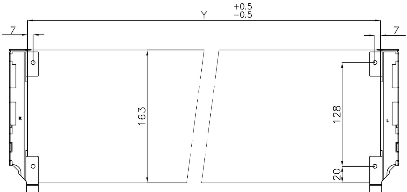
Ширина задней стенки (Y) = внутренняя ширина шкафа – 79 мм
