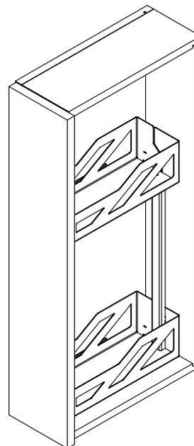
ШАГ 5. При помощи замков при необходимости можно провести регулировку полки по высоте.
