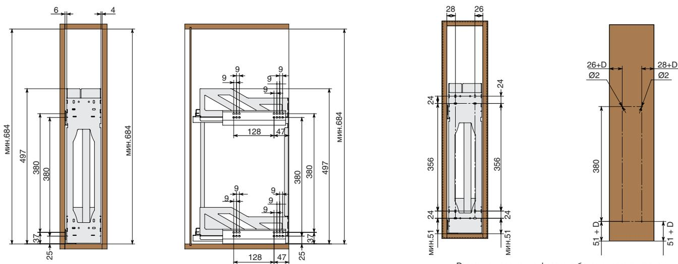
D-размер наложения фасада на боковую стенку каркаса.
