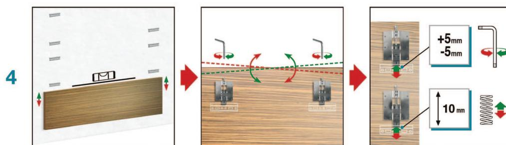
С помощью ключа- шестигранника SH.4 производим регулировку панели по уровню
