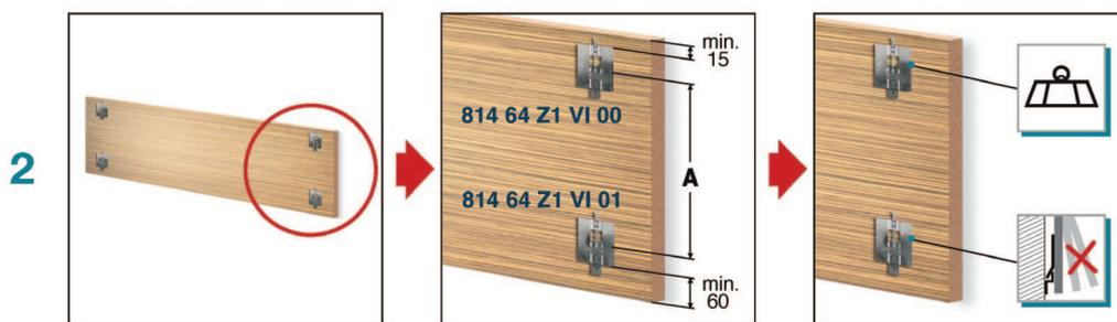
Устанавливаем фиксаторы на панель, согласно схеме.
