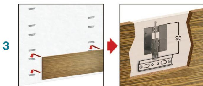
Навешиваем и фиксируем панель на кронштейнах
