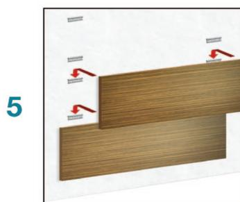
Устанавливаем и фиксируем следующую панель аналогично первой
